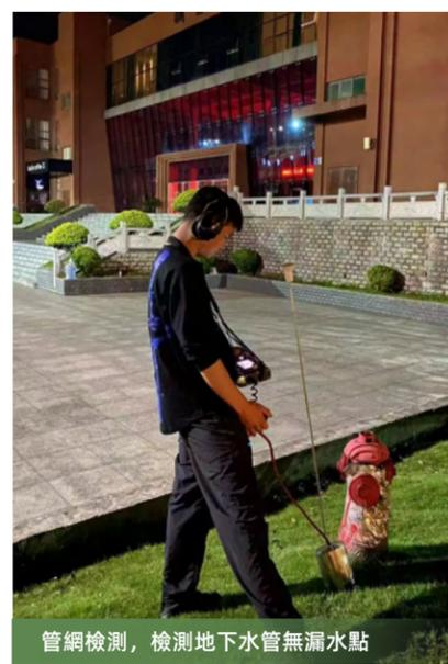
管網檢測，檢測地下水管無漏水點
